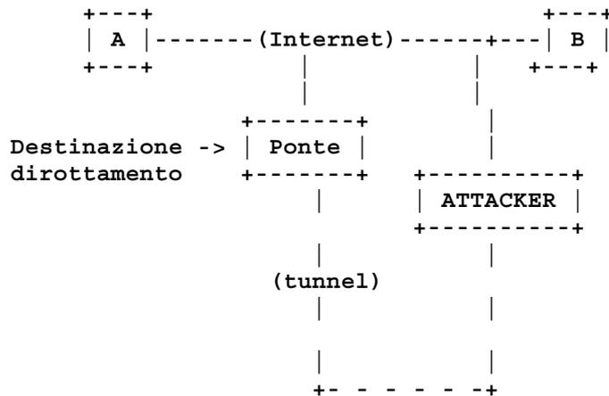
In seguito indicheremo come ATTACKER indifferentemente la box dell'attaccante o il router su cui ha un tunnel (Destinazione dirottamento).
